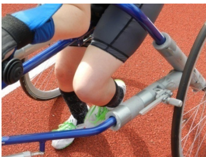
Figuur 13 Isolatiemateriaal om frame.
